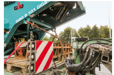
Die allseitige Belastbarkeit der RUD Anschlag- und Zurrpunkte ermöglichte es Gipo erstmals, trotz der kundenindividuellen Ausführung seiner Anlagen standardisierte Positionen für die Anbringung der Befestigungspunkte zu definieren. Quelle: Gipo
