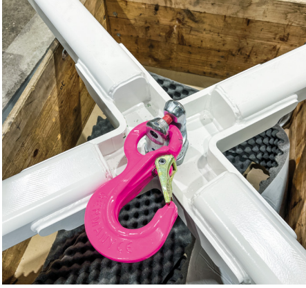
Bei Hebevorgängen in der Fertigung setzt Gipo ergänzend auch RUD PP-S PowerPoint Universalanschlüsse mit bis zu acht Tonnen Tragfähigkeit und Haken für Rundschlingen, Drahtseile oder Ring- und Hakengehänge ein. Quelle: Gipo
