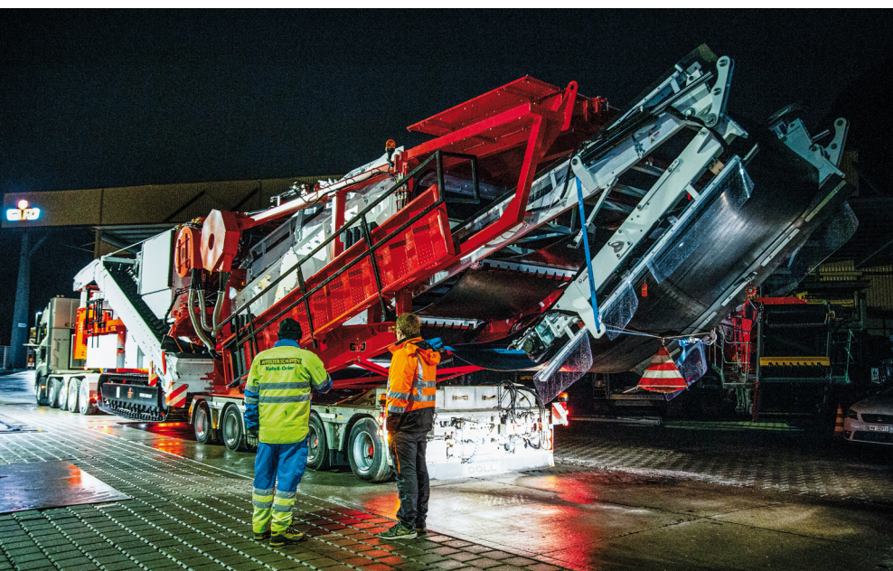
Bevor Brech- und Siebanlagen ihren Dienst aufnehmen können, müssen sie gewöhnlich über weite Strecken zum Einsatzort bewegt werden, zumeist im Straßentransport per Tieflader.
