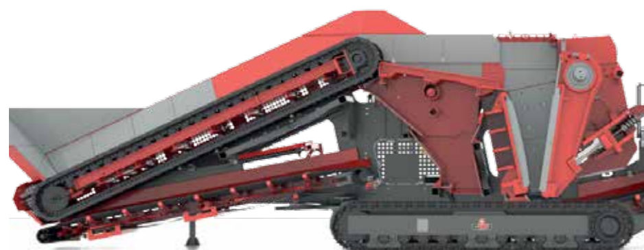
ALIMENTATION AVEC CONVOYEUR À TABLIERS MÉTALLIQUE ET PRÉCRIBLAGE
