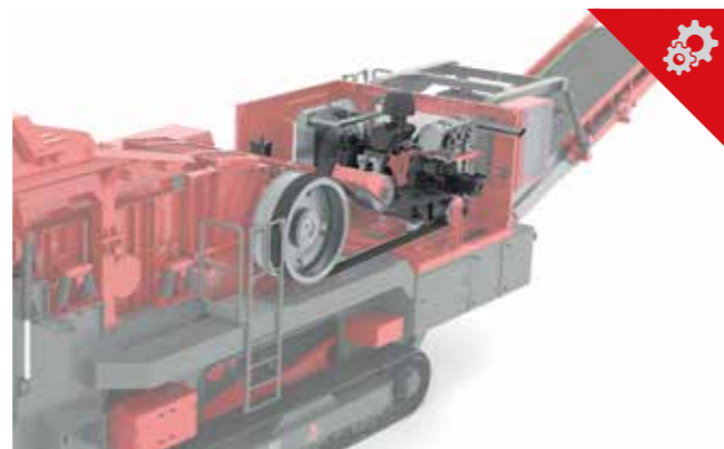
DIESEL – HYDRAULIQUE AVEC UN CONCASSEUR À ENTRAÎNEMENT DIRECT
