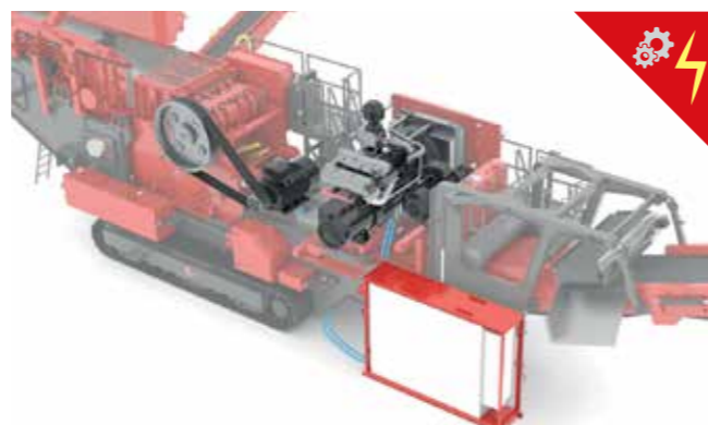
COMBINAISON DIESEL / ÉLECTRO-HYDRAULIQUE
