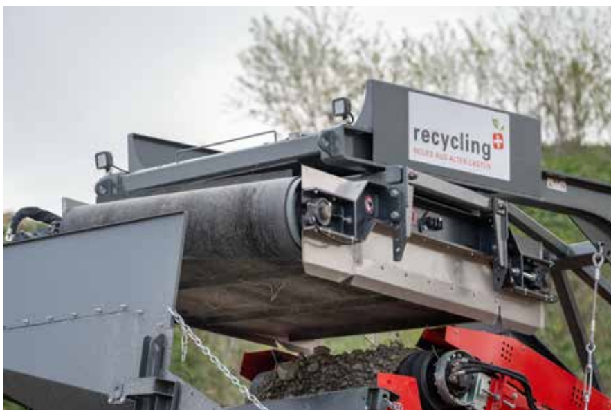
Ganz bewusst in Längsrichtung ist der Überbandmagnetabscheider angebracht.
