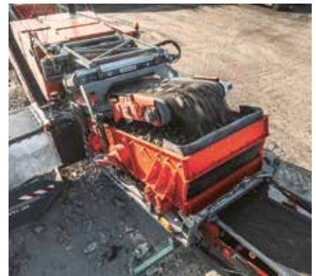
Unverzichtbar im Recycling: Windsichter (links) und der Eisenaustrag über ein hier quer eingebautes Magnetband.
